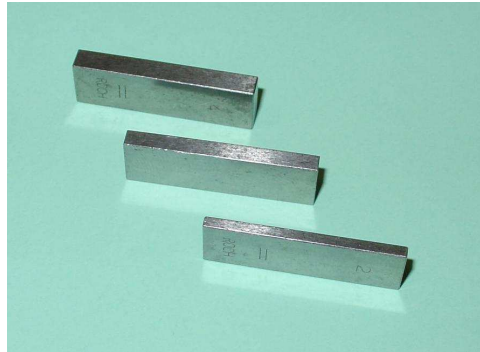
Cale de précision, de hauteur 4, 3 ou 2 mm
