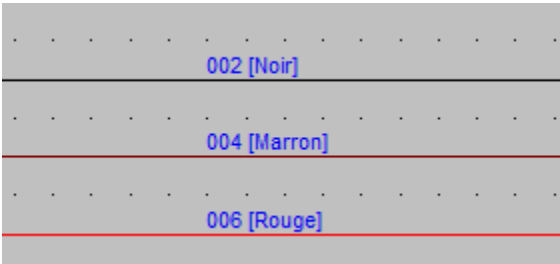
Exemple de numéros avec ajout de la couleur du conducteur.
